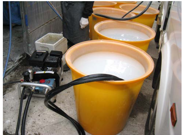
小型動噴による消石灰飽和液の散布
